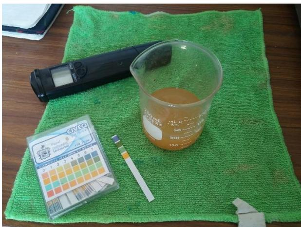
Figura 24. Instrumentos de medición para pH y conductividad eléctrica (CE) en soluciones nutritivas.
